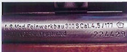
Typen- und Seriennummerstempel mit „F-im-Fünfeck“ bei einem Matchluftgewehr
